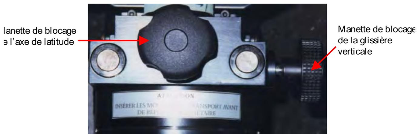
Avant de refermer le couvercle du planétaire, débloquer l'axe de latitude, placer le à l'horizontal et bloquer l'axe. Poser les blocs de mousse au fond du caisson, débloquer la glissière verticale, et faire coulisser l'ensemble au fond du caisson. Il est nécessaire d'exercer une pression sur le bloc coulissant afin de comprimer le bloc de mousse, avant de bloquer la glissière verticale. Bloquer l'axe de latitude.
