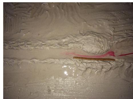
Figure 3 : Modélisation d'une solution proposée pour limiter l'érosion, la mise en renfort sur la berge. Test avec le colorant.
