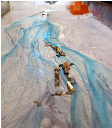
Figure 1 : Dans le BacFlows, suivi de l'écoulement d'un cours d'eau artificiel rencontrant des obstacles, rochers, grâce à un colorant bleu.
