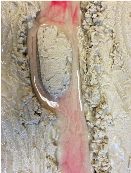
Figure 2 : Dans le BacFLOWS, suivi de l'écoulement d'un cours d'eau artificiel, dévié par une barre sédimentaire, grâce à un colorant rose.
